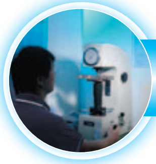
ROCK-WELL 硬度試験機 Hardness tester ロックウェル硬さ試験機
