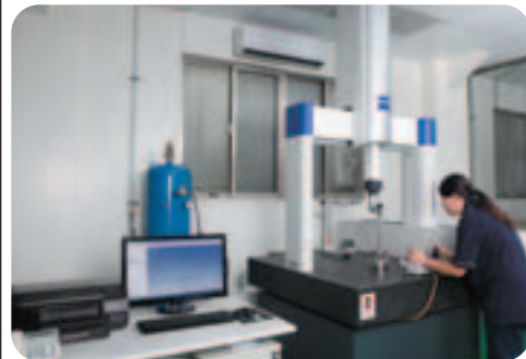
15 三次元檢驗 CMM inspection 三次元測定
